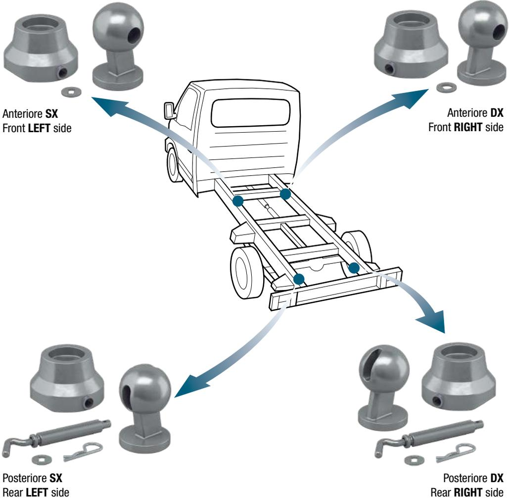
Per convenzione i perni delle sfere posteriori si intendono montati paralleli alla sponda posteriore.
