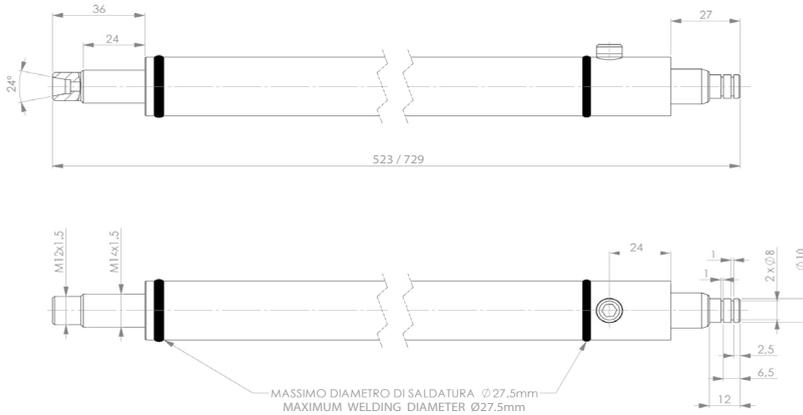
**Cilindro singolo effetto / Single-acting cylinder**
